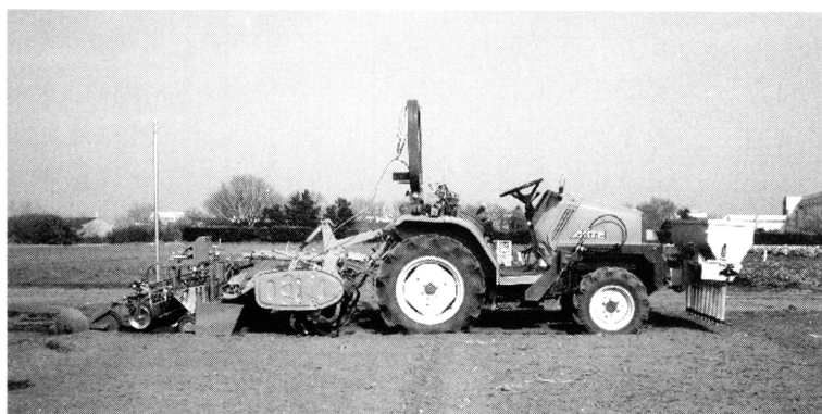
図1. 試作したマルチ内施肥機
